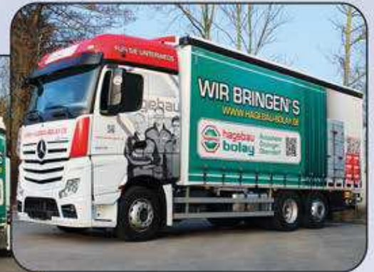
Curtainsider mit Schiebeverdeck für Kranbeladung
